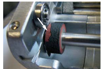
② Verschleißmarkierung Reibrad Rot = Austausch erforderlich
