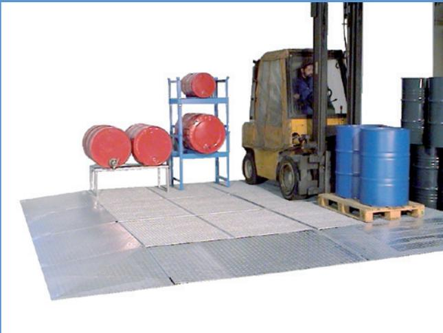
Flächenauslegungen dienen zur Lagerung und zum Um- und Abfüllen von gefährlichen Flüssigkeiten. Die Fläche kann an die örtlichen Gegebenheiten angepasst werden. Die Auffangwannen sind durch Wannerverbinder verbunden, das Auffahren erfolgt über Rampen. Je nach Ausführung kann die Fläche mit Hubwagen, Gabelstapler bzw. LKW befahren werden.
