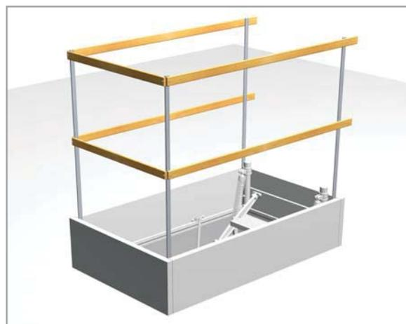
Lukenumwehrung aus Holz mit Stahlstützen (baurechtlich vorgeschrieben)
