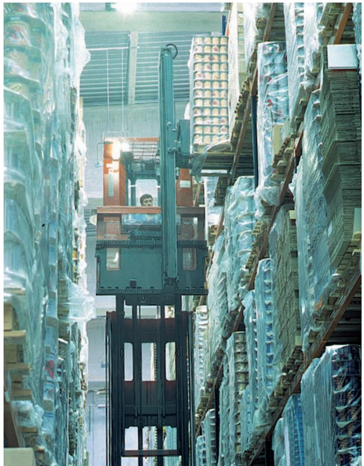
Schmalgangstapler bei der Lagerung/Entnahme.
