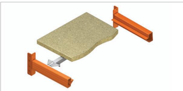
Diese Spanplattenböden benötigen keine Befestigung auf den Längsträgern J oder Z, da die Bodenkante auf dem inneren Profil des Längsträgers aufliegt und dadurch verdeckt bleibt. Je nach Last müssen entsprechende Querauflagen angebracht werden.
