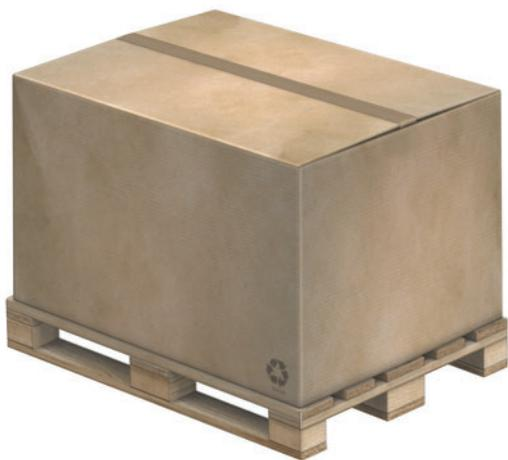
Die Paletten werden normalerweise von der Schmalseite her manipuliert, bedingt durch die Bauart z.B. einer Europalette (800 x 1.200 mm) mit drei unteren Schienen die in Längsrichtung (1.200 mm) angebracht sind, müssen diese wiederum in der Tiefe des Regalfeldes, senkrecht auf den Längsträgern aufliegen.
