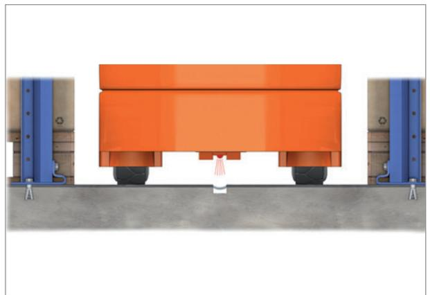
Im Einfahrbereich der Gänge mit mechanischer Führung werden Einfahrtrichter angebracht, die das Zentrieren der Stapler erleichtern.
