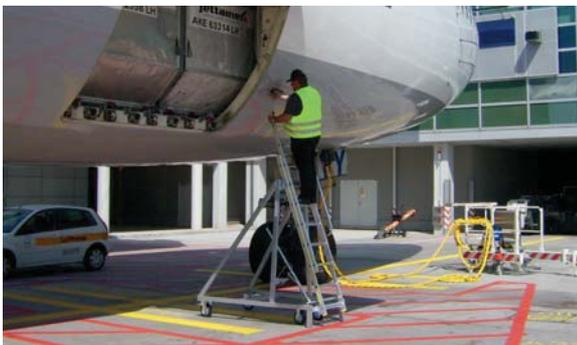
Die Hebel zum Öffnen der Ladeluken lassen sich bei allen Flugzeugtypen bequem erreichen und bedienen.
