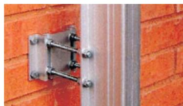
4. Befestigung für verstellbaren Wandabstand von 25 – 110 mm erfolgt mit Wandhalter und 4 beigefügten 100 mm langen Schrauben.
